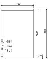
CWI1 = Attacco acqua freddaD = Scarico acquaEI = Connessione elettrica
